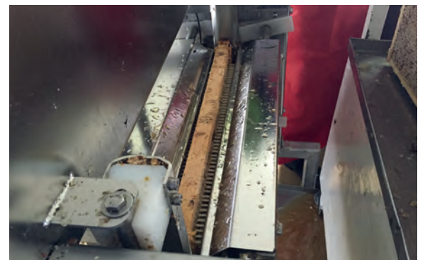
Wie auch die Imker in Australien setzen die meisten Imkereien eine Maschine zum Entdecken der Waben ein. Mit einem weiteren speziellen Gerät, dem Priker, stechen kleine Stocher in die Zellen und lösen den Manukahonig aus den Waben, bevor diese geschleudert werden.
